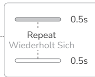
Wiring test status Status der Kabelprüfung
